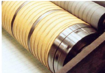
(Détail du cylindre cliché d'impression des barres phosphorescentes)
